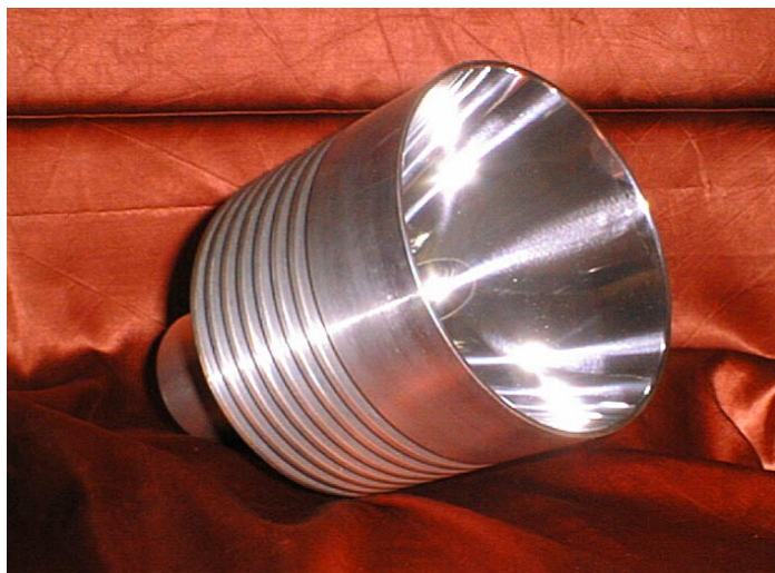
Réflecteur "Optique Fluide" ayant servi aux mesures.
