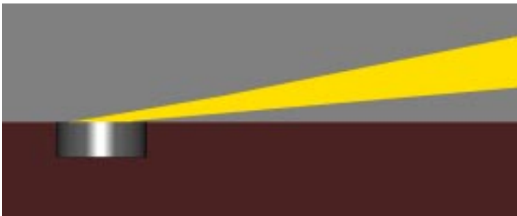
Vue de profil d'un balisage encastré sans saillie (Optique Fluide statique)
