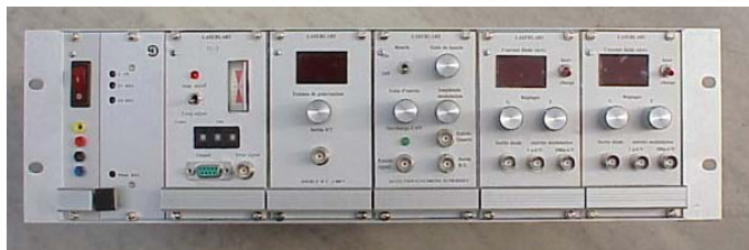
Système de contrôle pour diode laser : contrôle courant et température - module amplificateur haute tension - module détection synchrone numérique. Application au contrôle et asservissement en fréquence d'une diode Laser.
