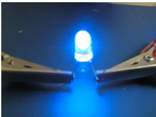
Diode en fonctionnement alimentée sous son intensité nominale de 40 mA
